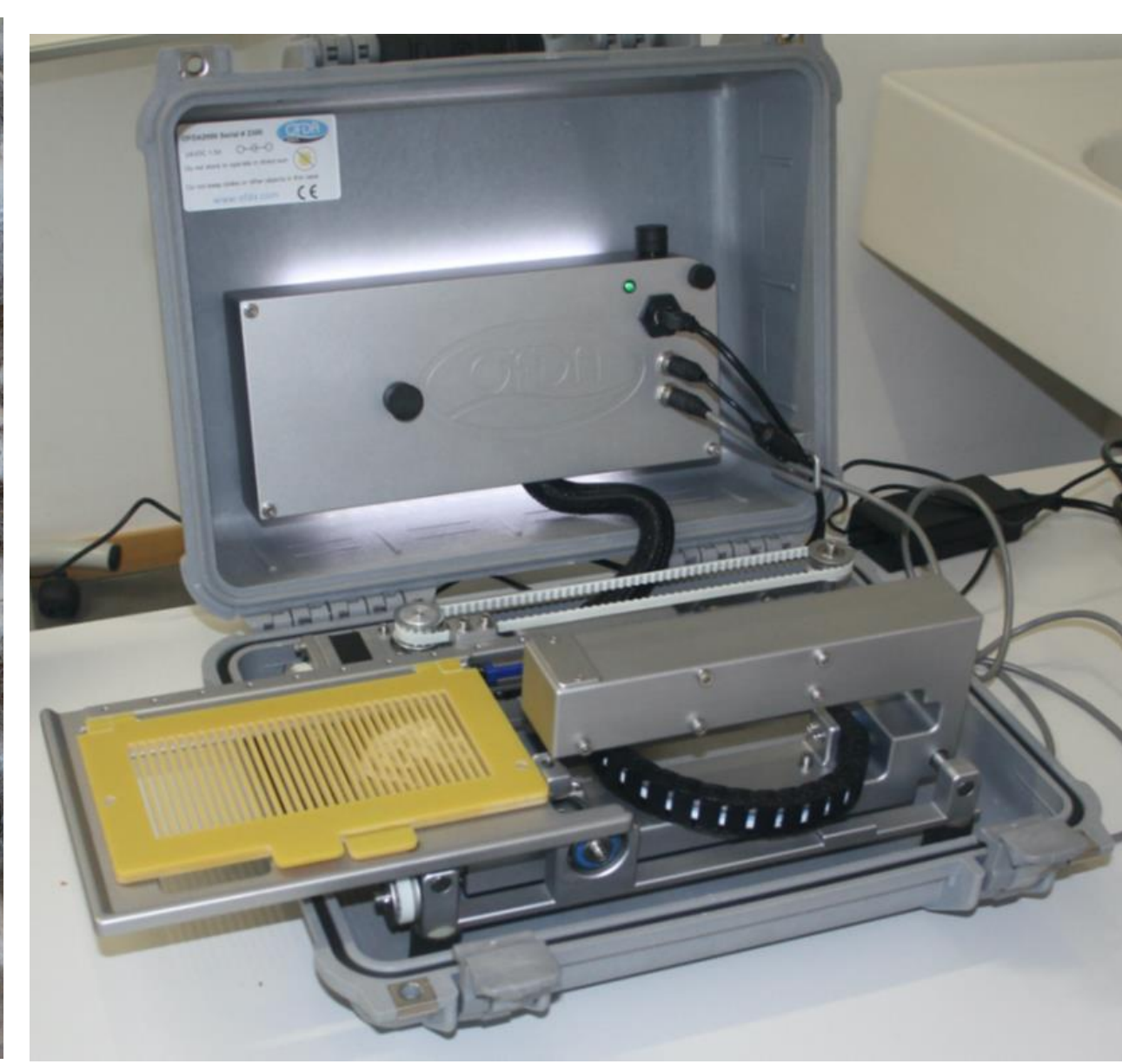
Abb.7: Optisches Fasermessgerät OFDA2000 zur Erhebung der phänotypischer Wollparameter wie Feinheit, Länge, Kräuselung, Komfortfaktor
